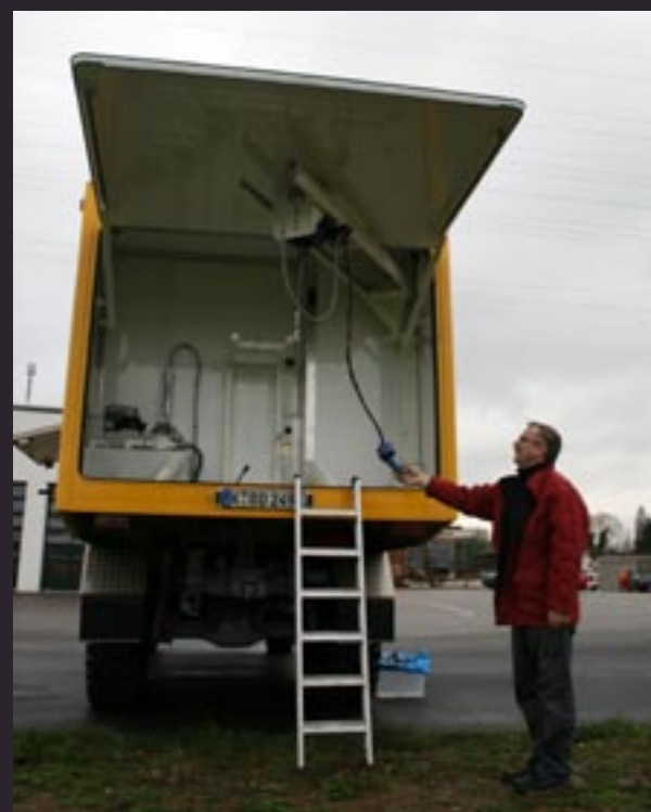
Die Klappe öffnet mit wenigen Pumpbewegungen hydraulisch. Der Krahnkorb nimmt eine 1000er BMW GS passgenau auf und hievt sie elektrisch an Bord.
