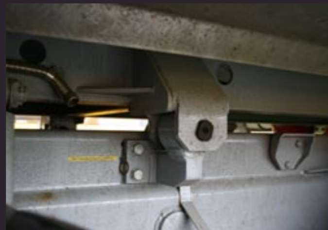
Mit 4 wuchtigen Bolzgelenklagerungen krallt sich der Zwischenrahmen an den KAT.
