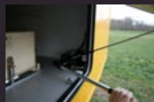
Die Klappe öffnet mit wenigen Pumpbewegungen hydraulisch. Der Krahnkorb nimmt eine 1000er BMW GS passgenau auf und hievt sie elektrisch an Bord.
